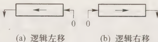
图 6.4 实现逻辑左移和右移操作的硬件示意图
